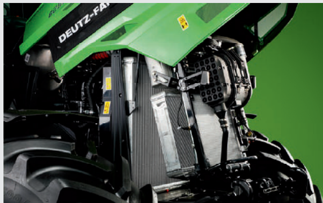
↑ Лесен достъп до радиатора и въздушните филтри.
