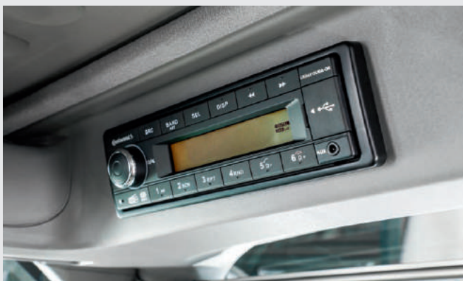
↑ Новият DAB+ радио с 4 тонколони и функция "Handsfree", интегрирани в новият InfoCentre pro .
