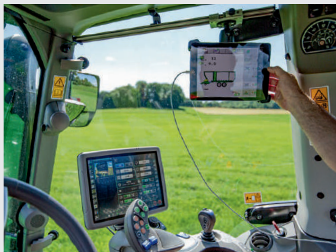
↑ Допълнителна релса за „външни“ монитори (примерно за инвентара).
