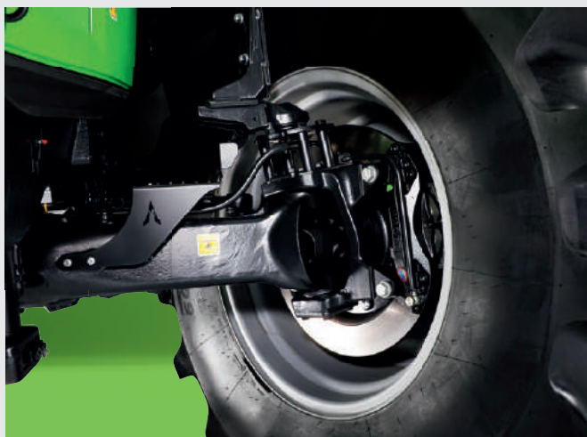
↑ Сухи дискови спирачки за максимално спирачно усилие.
