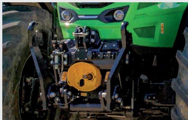
↑ Преден навес с капацитет 5450кг. и преден ВОМ с 2 скорости.
