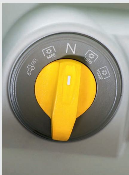
↑ Електрохидравличен превключвател на оборотите на BOM-а.
