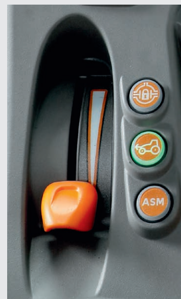
↑ Електрохидравлично задействие на 4WD, блокаде и системата ASM.
