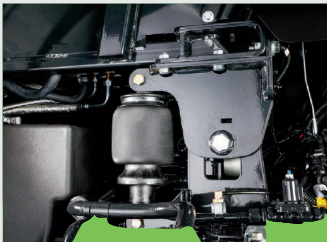
↑ Пневматично окачване на кабината за комфортна езда.
