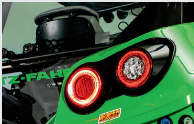
↑ Мигачи с LED светлини - за безопасност и модерна визия.
