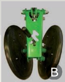
9 Избор между "V" образни самопочистващи се притъпкващи колела 2"(A), 1" (B), стомана (C) и каучукови Farmflex (D)
