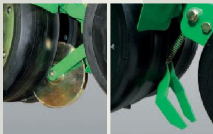
Малко колело (каучук или неръждаема стомана) за допълнително притпкване. Монтирано непосредствено до семепровода то фиксира незабавно семето в почвата.
