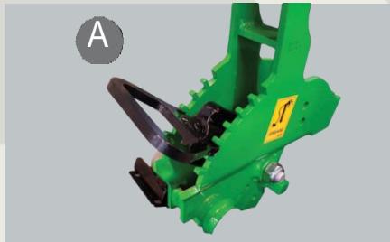
7 Ръчни лостове за регулиране на дълбочината на сеитба(A) и натиск(B) позволяват бързо и лесно да се променя настройката на машината. Една и съща настройка може лесно да бъде възпроизведена върху всички секции. Тези устройства не се влияят от прах и мръсотия.
