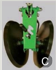
9 Избор между "V" образни самопочистващи се притъпкващи колела 2"(A), 1" (B), стомана (C) и каучукови Farmflex (D)
